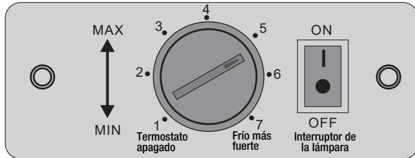
La heladera exhibidora posee un control de termostato mecánico que controla la temperatura, fácil de operar.
